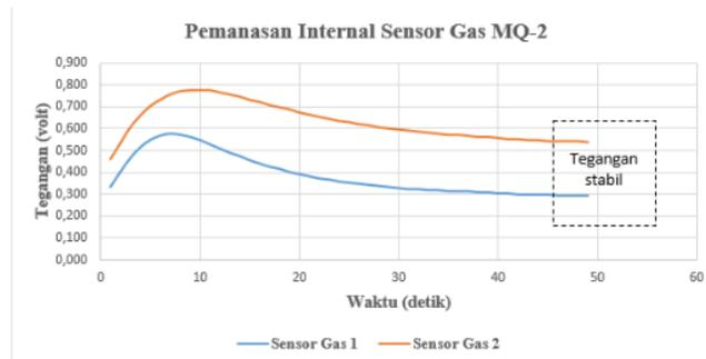
Gambar 3 Grafik pemanasan internal sensor gas MQ-2
