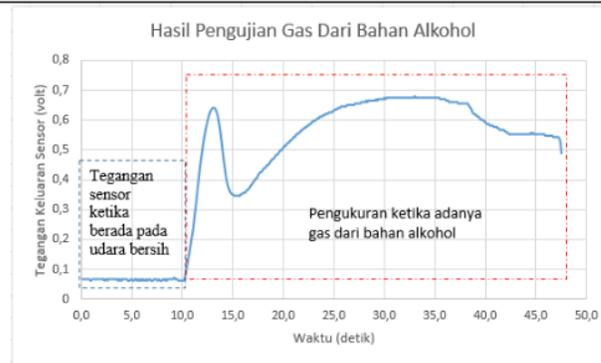
Gambar 4 grafik hasil pengujian gas dari bahan alkohol
