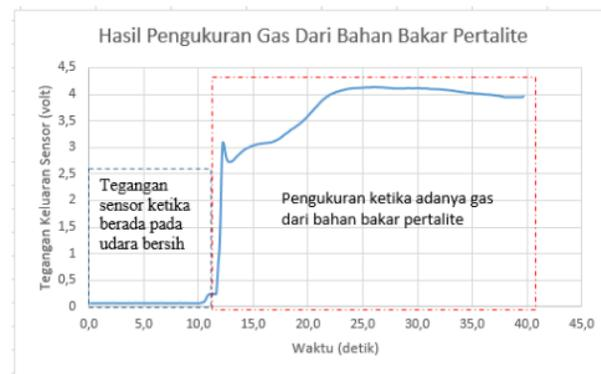
Gambar 5 grafik hasil pengujian gas dari bahan bakar peralite
