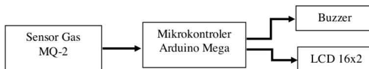
Gambar 1 Diagram blok sistem pendeteksi gas
