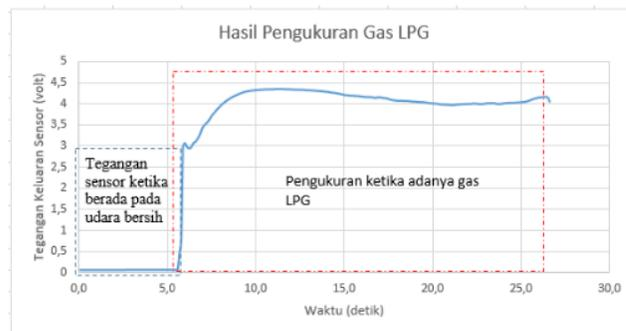
Gambar 6 grafik hasil pengujian gas LPG
