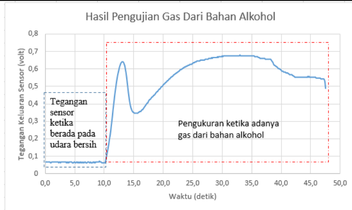
Gambar 4 grafik hasil pengujian gas dari bahan alkohol
