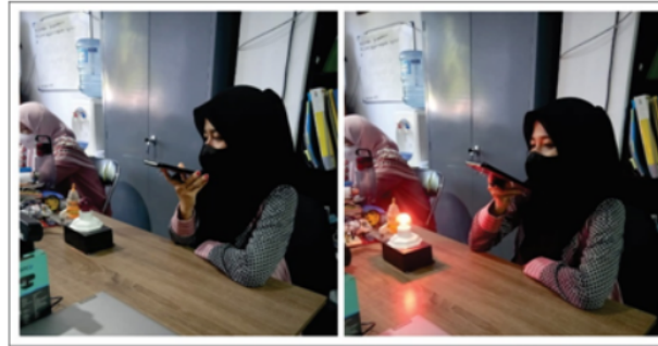
Gambar 11. Pengujian kontrol lampu pada sistem smart home menggunakan perintah suara
