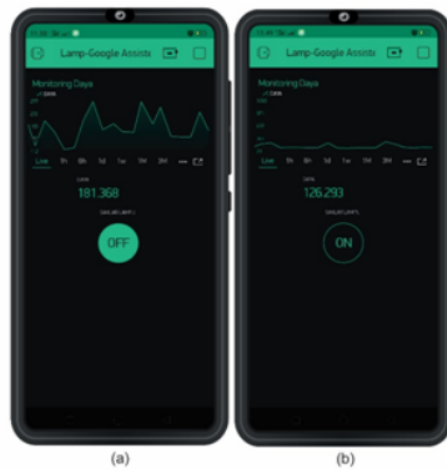
Gambar 9. Hasil antarmuka Blynk ketika dijalankan, (a) ketika lampu di aktifkan, (b) ketika lampu di non aktifkan
